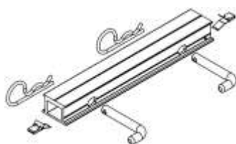
Dome 6 Connector (cas de la longueur 195 mm)
